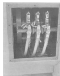
Slika 11 Detalj sklopa kliznih koluta i držača četkica
